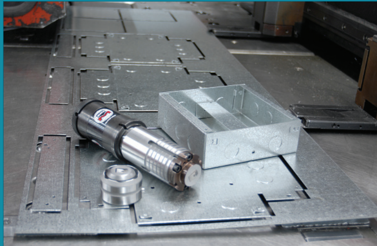
La herramienta SnapLock permitió incrementar la producción de cajas eléctricas en un 85% y reducir los costes en un 20%. El ensamblaje de las cajas se realizó sin soldaduras ni tornillos
