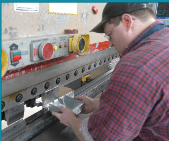
No se requiere soldadura por puntos ni pintura de acabado exterior, ya que los modelos se punzonan y plegan a partir de material en chapa prelacada y revestida
