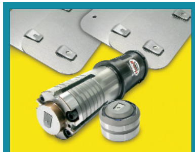
La herramienta de sellado por enganche SnapLock de Mate produce pestañas de acoplamiento automático accionadas por resorte que se enganchan firmemente en los agujeros previamente perforados
