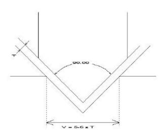
chapa y que el pequeño radio del punzón penetra en la chapa. Si además le aplicamos un gran tonelaje elim inaremos los posibles efectos del retorno elástico de la chapa. Este es el motivo por el cualel acuñado necesita un tonelaie entre 5 y 8 veces superior al del plegado a fondo. Para este tipo de plegado la anchura de la V suele ser de 5 veces el espesor de la chapa para reducir la penetración de la punta del punzón en la pieza
