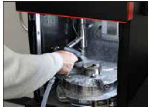
La Pistola llega a todas partes y facilita la limpieza de la máquina y el útil, antes y después de efectuar los afilados.
