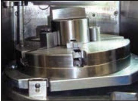
**La Rectificadora Premia incluye** un plato angular regulable para poder afilar el punzón con distintos sistemas de afilado, como rooftop, whisper, o one-way, para realizar la operación de forma sencilla. Simplemente desbloquee el plato y gradúelo a los grados adecuados al tipo de afilado, hasta 12°.
