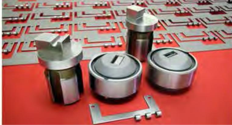
Las deformación de bisagras en la punzonadora podría eliminar el costo de una punzonadora detorreta especializada o de utillaje de estampado necesario para crear bisagras. Los deformados creados en una punzonadora tienen más exactitud que las operaciones manuales secundarias.
