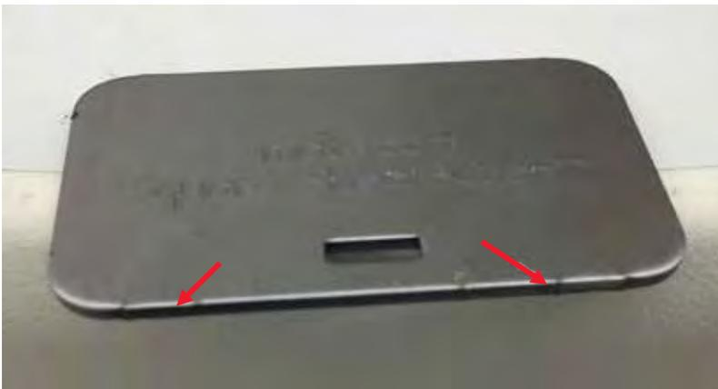
Shearbutton Cuadrado (deformado hacia abajo) después de la extracción de la chapa muestra un borde liso.
