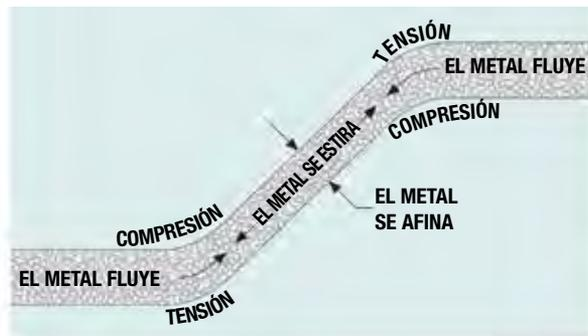
QUE SUCEDE EN UNA DEFORMACIÓN POR EMBUTIDO (SECCIÓN TRANSVERSAL)
