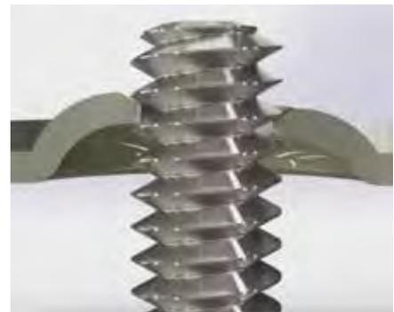
Figura 1: Vista transversal de la chapa metálica, realizada con la herramienta híbrida de deformado de rosca. Muestra que el material ha sido adelgazado cuando se creó la hélice del deformado de rosca de modo que el material se ajuste al paso de la rosca del tornillo.
