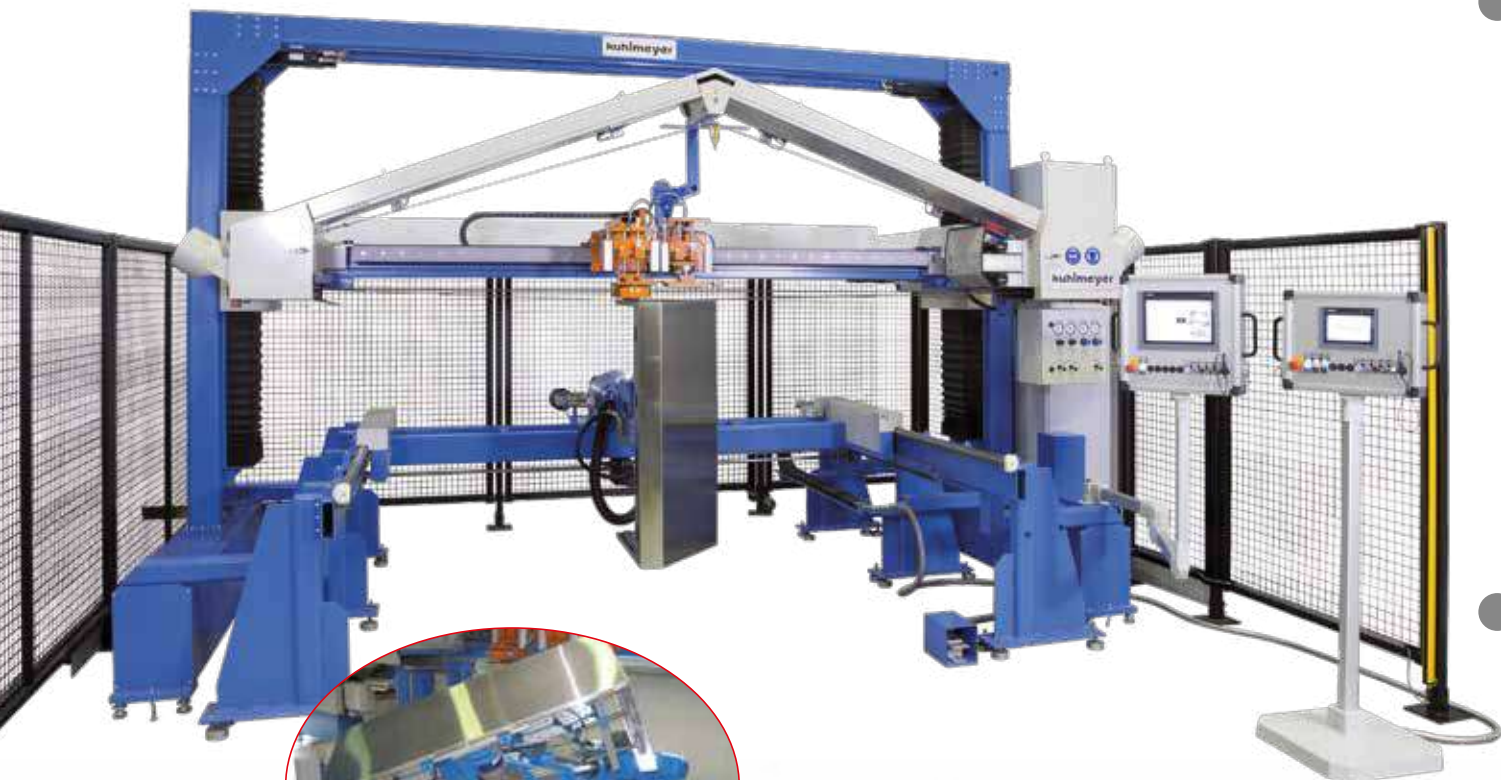
Desbarbadora pulidora Kuhlmeier modelo PZM automática, para piezas de grandes dimensiones.
