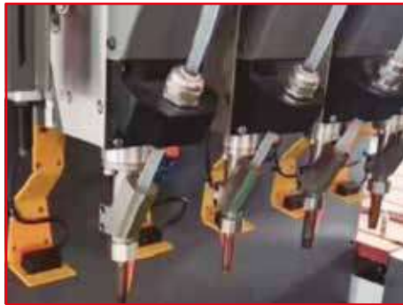
Detector de presencia del perno (Triple control).
