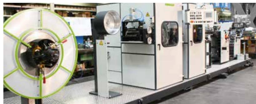
— Línea de rebobinado con tecnología de enderezado de la curvatura transversal
