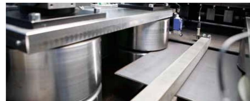
— Enderezadora de la curvatura transversal para láminas de metal gruesas
