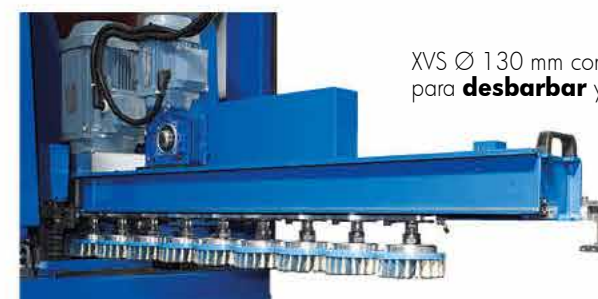
XVS Ø 85 mm con puas de alambre, eliminan el óxido en los cantos
