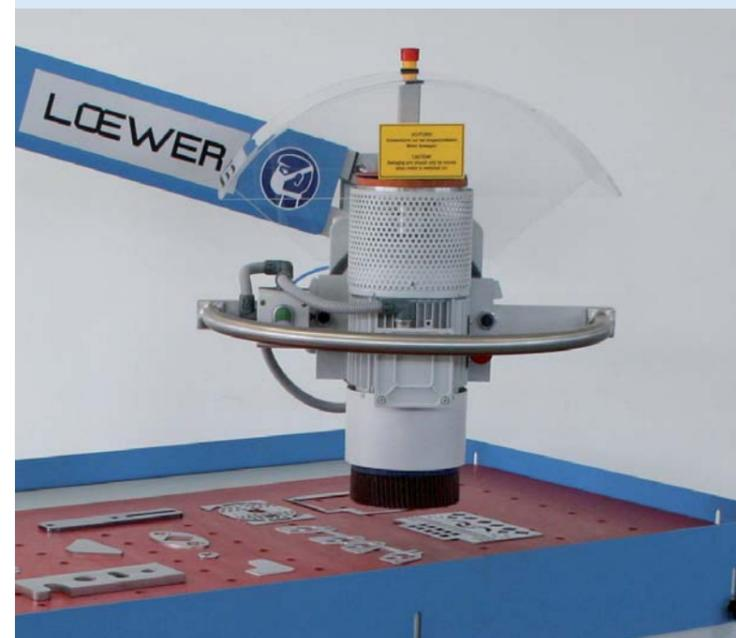
Para chapa cortada a láser, punzonada y cortada a plasma
