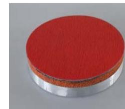
El Disco-Blando se usa para desbarbar utilizando abrasivos standard con velcro. El abrasivo blando asegura un desbarbado bastante agresivo en los cantos sin tener que aplicar mucha fuerza en la superficie. El disco blando elimina rebabas fuertes en la parte interior y exterior de los cantos.
