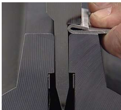
Predoblado y aplanado en la misma herramienta
